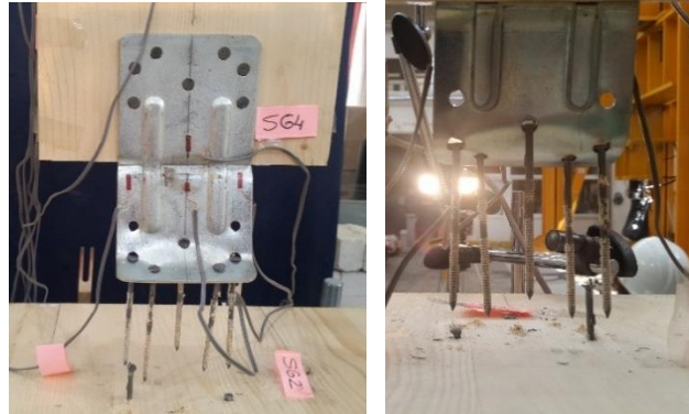
Şekil 5.9 MTS-RN-A-01 deneyi sonucunda birleşimin görünümü
