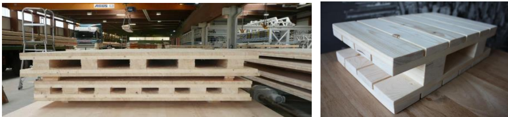
Şekil 3.20 Glulam ve CLT panelin birlikte kullanıldığı kaset sistem [118]
