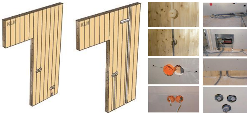
Şekil 3.9 Tesisat kanallarının oluşturulması [12]
