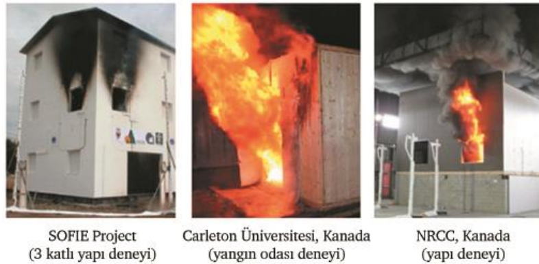
Şekil 3.33 CLT panel yapı sistemlerinin yangın deneyleri [134-136]
