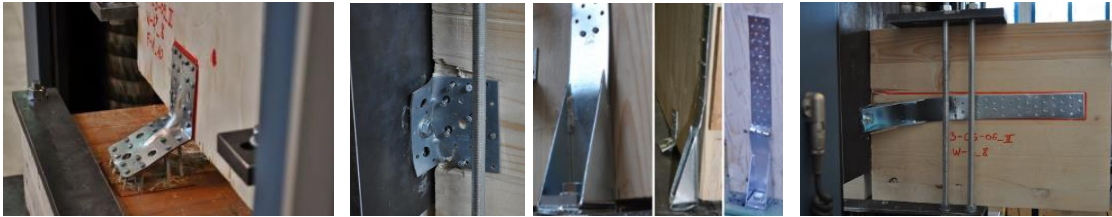
Şekil 4.33 CLT panel birleşimlerinde hasar türleri [184]
