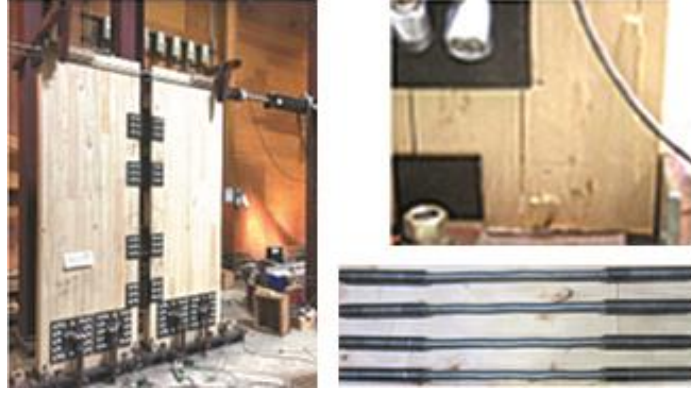
Şekil 4.17 Ardgermeli CLT panel birleşimleri ve enerji sönümleyiciler [145]
