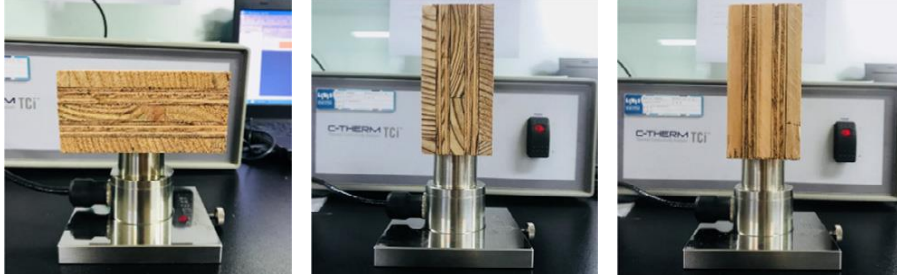
Şekil 3.21 CLT panelin ısı iletkenliğinin ölçümü [16]
