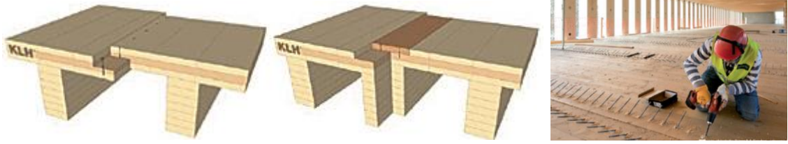
Şekil 3.16 Nervürlü döşeme sistemi ile açılı çivi/vida uygulaması [113]
