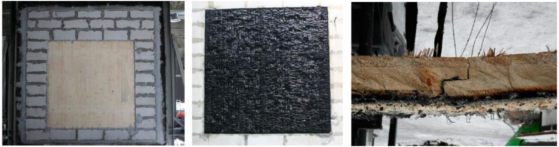
Şekil 2.9 CLT panellerin yangın öncesi ve sonrasındaki durumu [62, 63]
