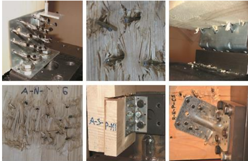
Şekil 4.30 Panel birleşimi deneylerinde gerçekleşen hasar türleri [167]
