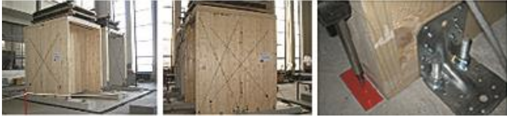
Şekil 4.26 Duvar paneli deney örnekleri ile birleşim detayı [158]
