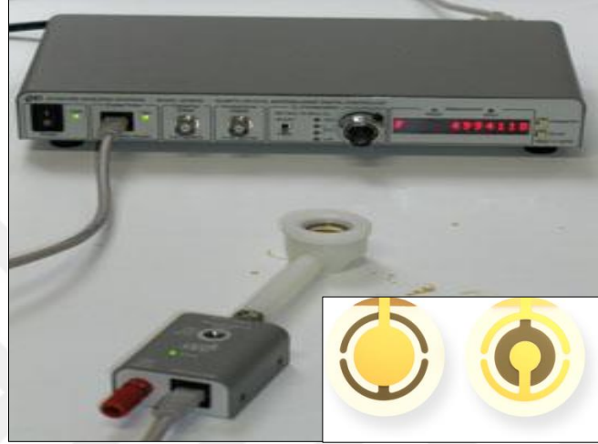
Şekil 3. 3 QCM 200 cihazı ve 5 MHz'lik AT kesim altın kaplı kuvars kristal elektrotlar
