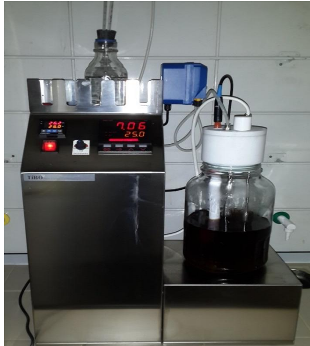
Şekil 3.2 Biyoreaktörde büyük ölçekli parazit üretimi
