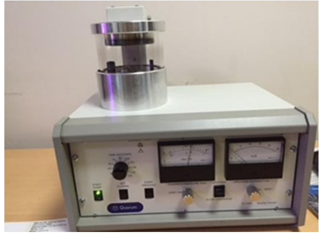
Şekil 3.5 Liyofilize edilmiş bir miktar örneğin karbon bant üzerine aktarılması ve örneğin altın kaplanması
