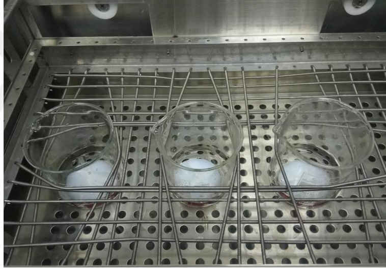
Şekil 3.9 Diyaliz kapsül içine yerleştirilen nanopartiküllerin salım aşamasındaki görüntüsü
