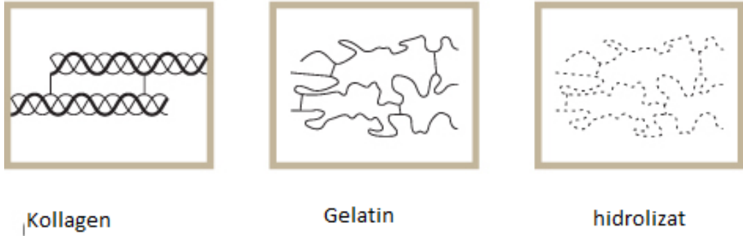
Şekil 2.22 Kolajen, jelatin, hidrolizatın şematik gösterimi [109]
