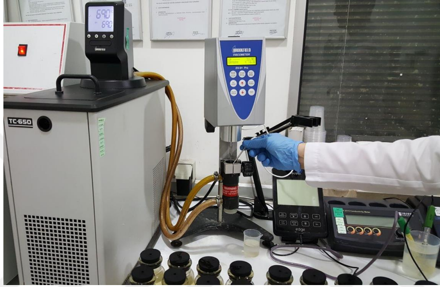
Şekil 3.2 Hidrolizat-jelatin karışımında viskozite tayini
