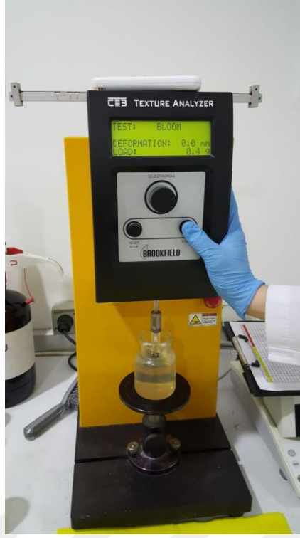
Şekil 3.3 Kıvam arttırıcılar-jelatin karışımı bloom ölçümü
