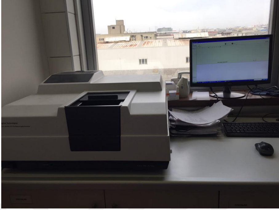
Şekil 3.4 Renk ve berraklık testlerinin yapıldığı UV cihazı
