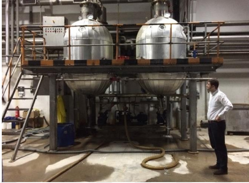
Şekil 2.18 Hidrolizat üretimi için kullanılan evaporatör
