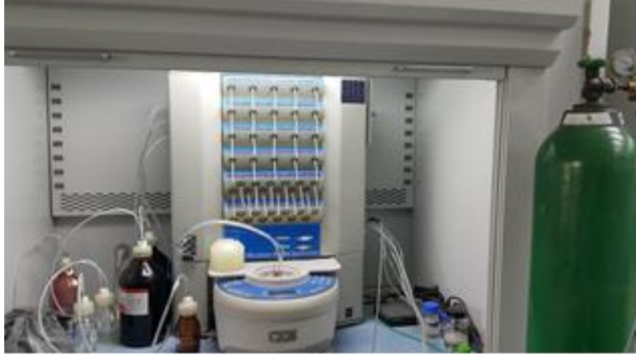
Şekil 3.1 Mikrodalga destekli peptit sentez cihazı
