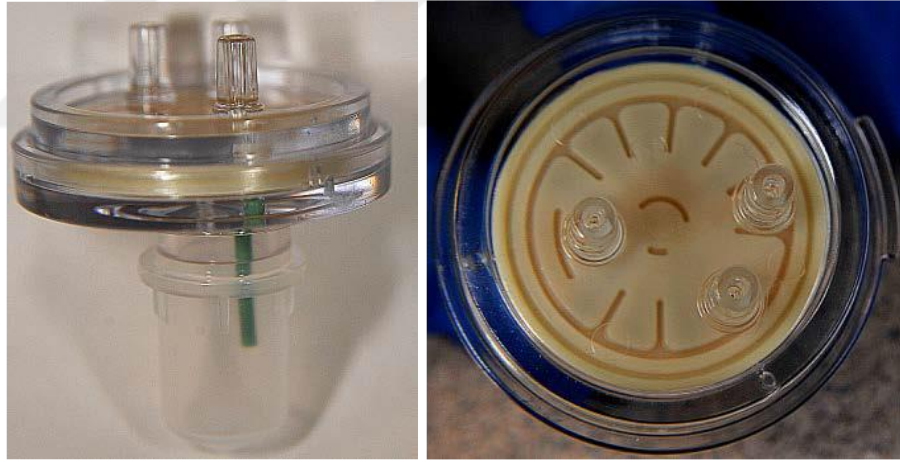
Şekil 3. 6 Emülsiyon PZR için kütüphane ve yağ moleküllerinin birleştirildiği port
