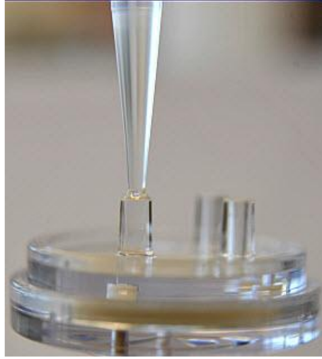
Şekil 3. 7 Porta örnek ve yağ yükleme aşaması
