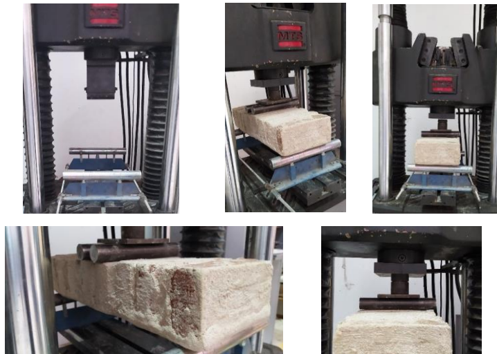
Şekil 4. 12 Yığma kiriş eğilme testi düzeneği.
