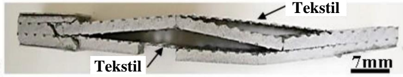
Şekil 2. 33 Matris ile epoksi kaplamanın kimyasal uyumsuzluğu nedeniyle oluşan delaminasyon hasarı [87].
