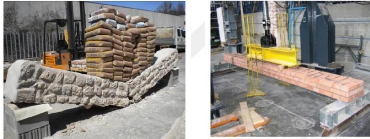
Şekil 2. 62 Yığma kirişlerde gerçekleştirilen eğilme testleri [152], [153].
