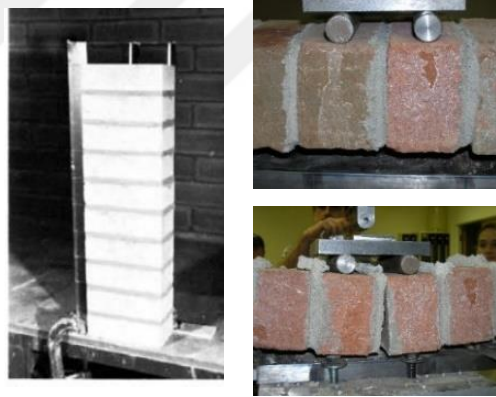
Şekil 4. 10 Yığma birimlerin eğilme testi [162].
