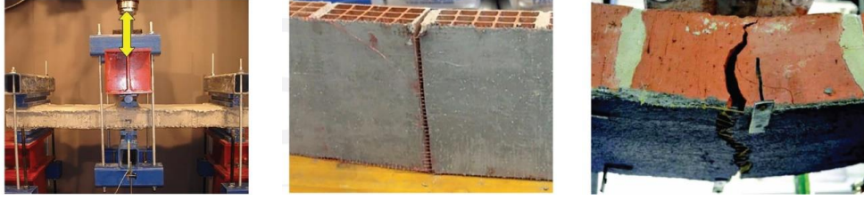
Şekil 2. 58 Orta ölçekli numunelerle gerçekleştirilen düzlem dışı eğilme testleri[142] [148].
