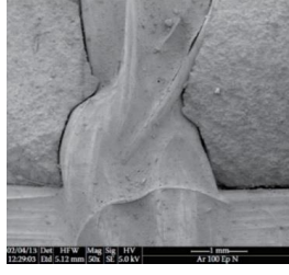
Şekil 2. 27 Çimentolu matris içinde örme kumaş bağlantı noktası [59].
