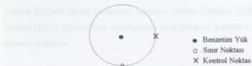
**Şekil 3.1.** İletken kesit yüzeyi üzerinde yük, sınır noktası ve kontrol noktası
