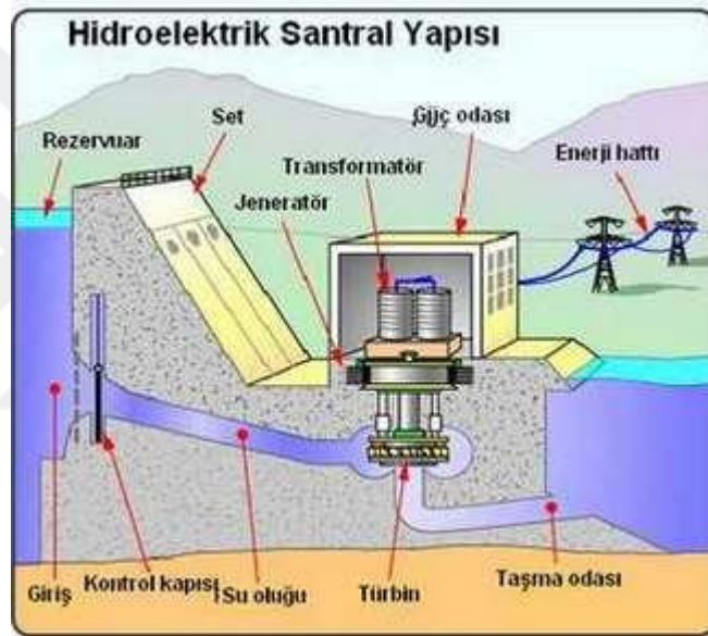
Şekil 2. 6 Hidroelektrik santrali çalışma prensibi
