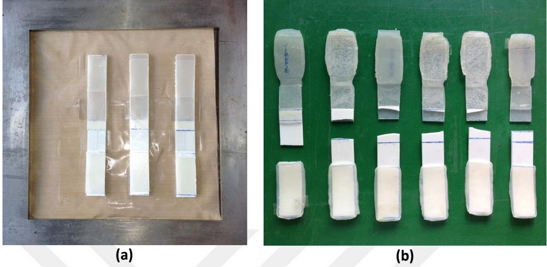
Şekil 7.13 Bindirmeli-kayma test numunesi: a) hazırlama, b) test sonrası görüntüleri
