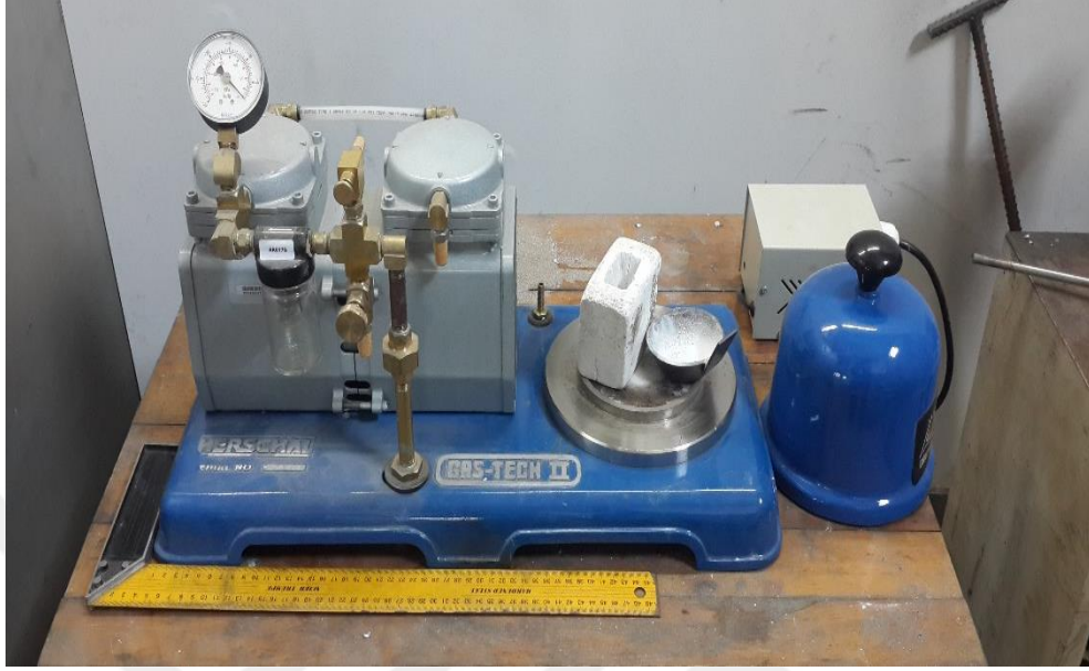
Şekil 3.10 Vakum altında katılaştırılma (VAK) cihazı.
