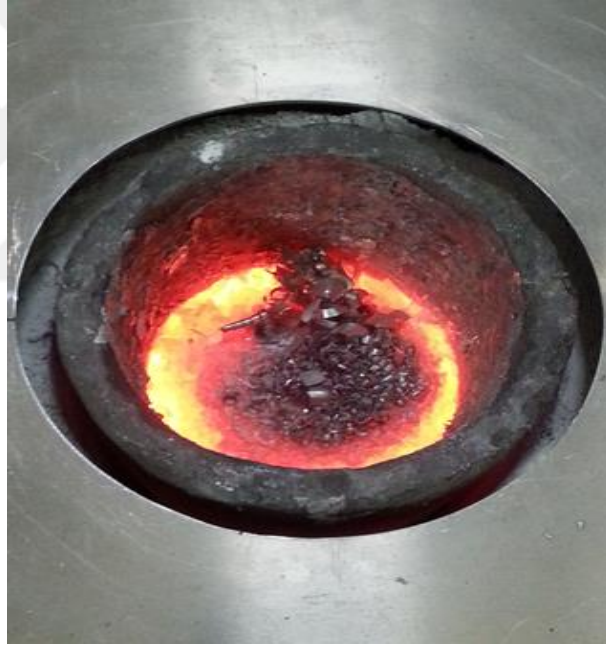
Şekil 3.9 Ergitme sırasında karşılaşılan yanlış talaş eklenmesi.
