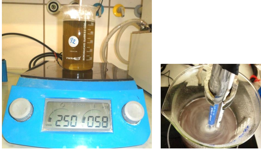
Şekil 5. 6 Liç çözeltilerindeki bakırın çöktürülmesinde kullanılan deney düzeneği
