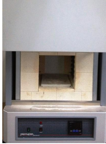
Şekil 5. 8 Ergitme deneylerinde kullanılan kamara tipi fırın
