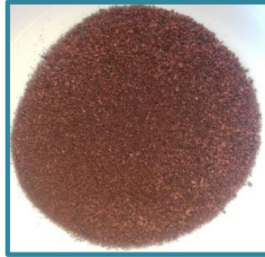
Şekil 6.11 Çözeltiden çöktürülen bakır
