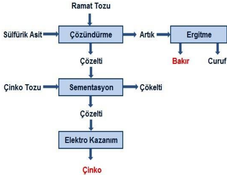
Şekil 6. 15 Pirinç artığından bakır ve çinko geri kazanımına yönelik uygulanan prosesin akım şeması
