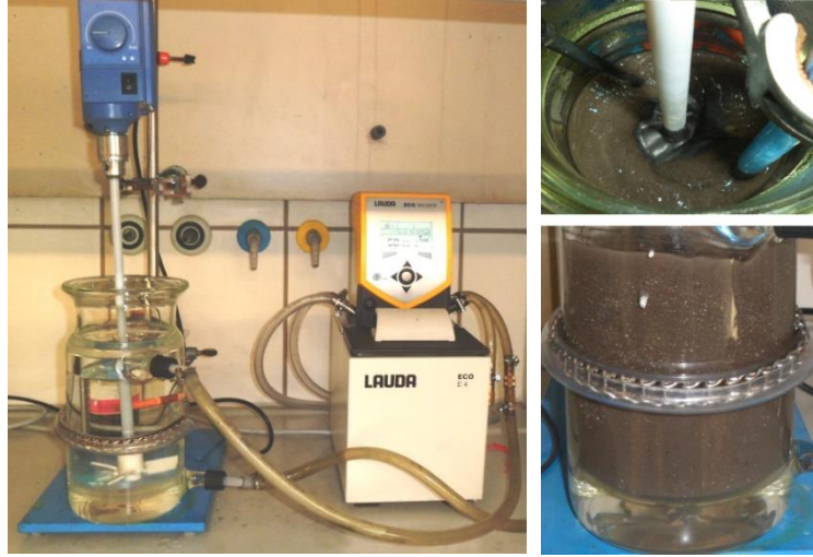
Şekil 5. 4 Klasik liç işleminde kullanılan deney düzeneği
