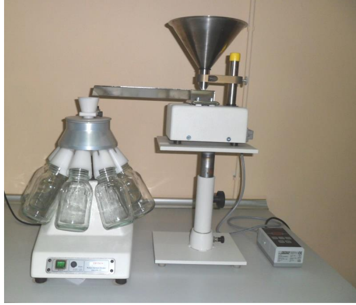
Şekil 5. 1 Analiz öncesi atıkların fiziksel olarak homojenleştirilmesinde kullanılan ayırma cihazı
