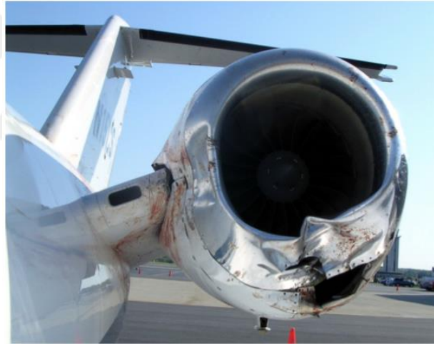
Şekil 2.12 Cessna-525 uçağının kuş sürüsüne çarpması [21]
