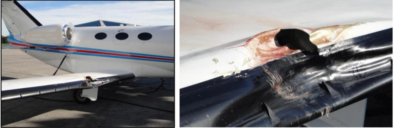
Şekil 2.14 Citation Mustang uçağının kanat hücum kenarına çarpma hasarı
