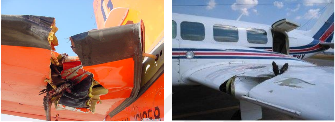
Şekil 2.26 Kuş çarpması hasarları [35]
