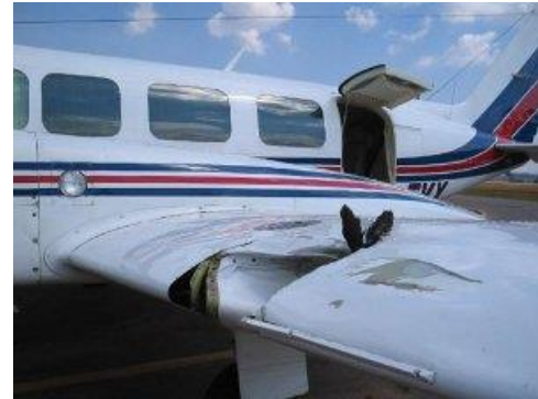
Şekil 2.17 Kanat hücum kenarındaki yapısal hasarlar
