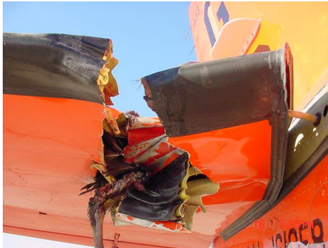
Şekil 2.17 Kanat hücum kenarındaki yapısal hasarlar
