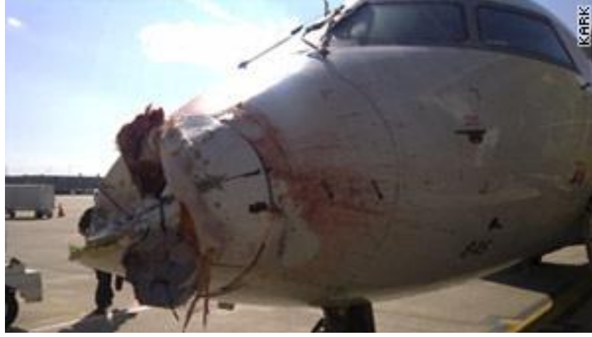
Şekil 2.11 Atlantik Güneydoğu Havayolu'na ait uçağa kuş çarpması hasarı
