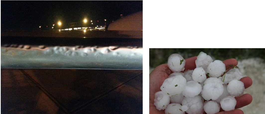
Şekil 2.19 Yatay stabilize kanat hücum kenarında dolu yağışı hasarı
