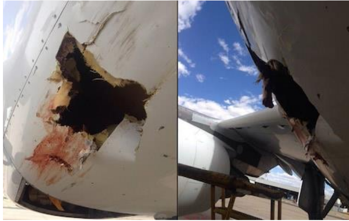
Şekil 2.8 A319-100 uçağının gövdesindeki delik hasarı [25]
