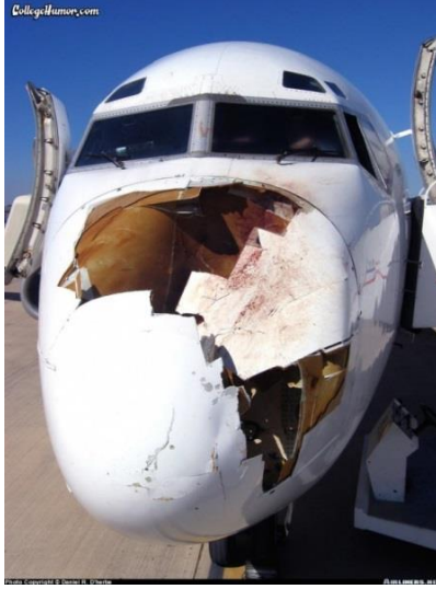
Şekil 2.15 Radom ve kanat hücum kenarı üzerinde yapısal hasar örnekleri
