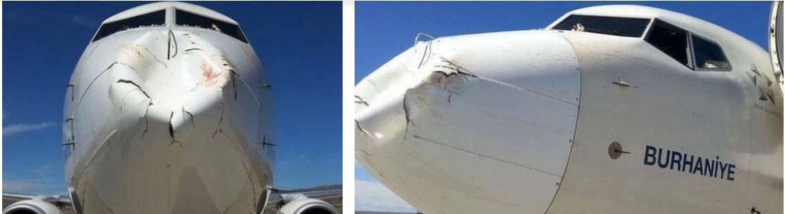
Şekil 2.10 Türk Hava Yolları Boeing 737-800 uçağına kuş çarpması hasarı
