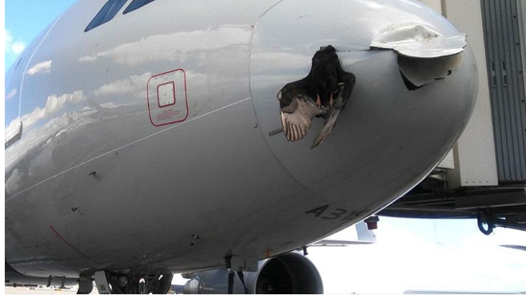
Şekil 2.7 Amerika Havayolları'na ait yolcu uçağının radomunun parçalanması [24]
