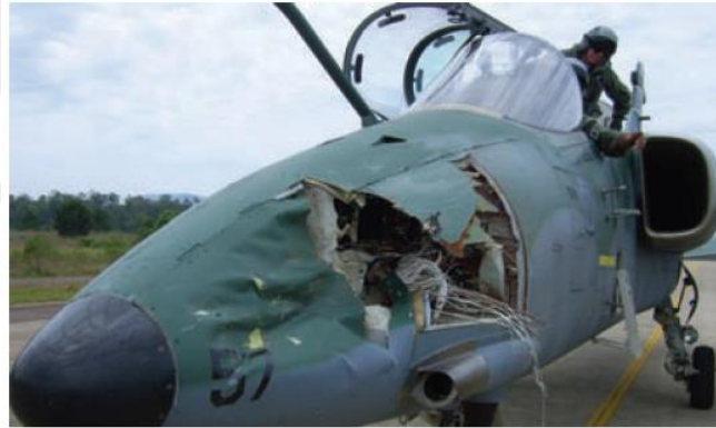
Şekil 2.16 Askeri uçağa kuş çarpması sonucu oluşan hasar
