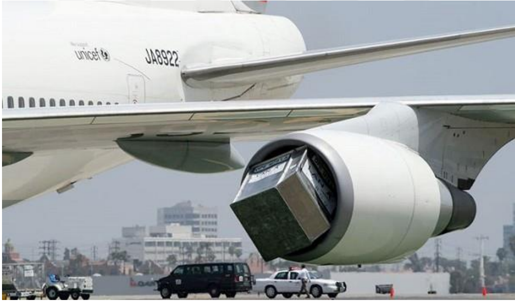
Şekil 2.31 Uçak etrafındaki kazalar ve yerdeki hasarlar [36]
