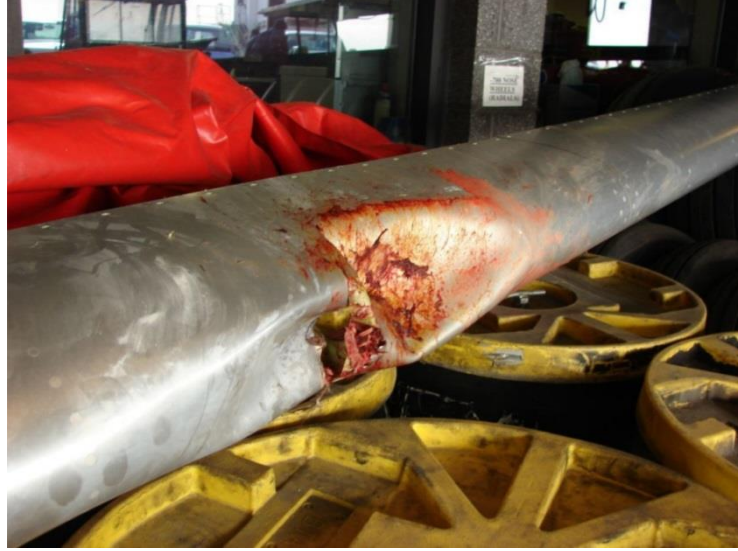
Şekil 2.13 B737 uçağının sol kanat hücum kenarına kuş çarpması hasarı [23]
