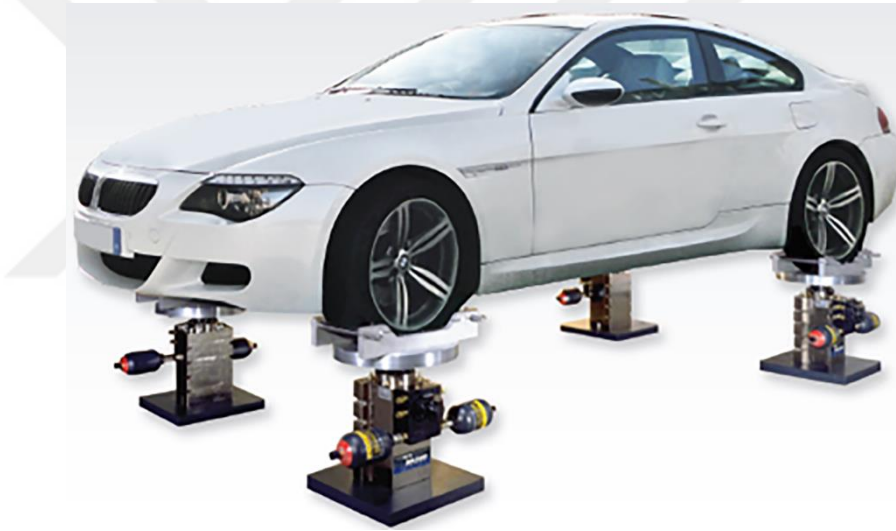
Şekil 1.1 Örnek bir 4-Poster Test Sistemi [16]
