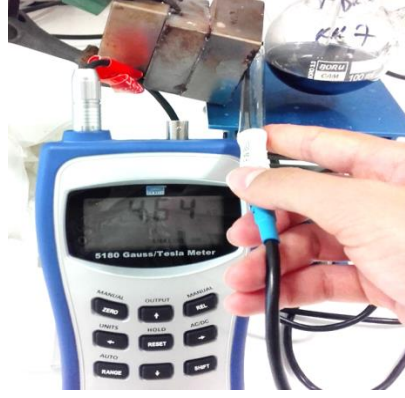
Şekil 3. 6 MA altında gerçekleştirilen sentezler sırasında kullanılan sürekli mıknatıs ve manyetik alan akış yoğunluğunu ölçmek için kullanılan Gaussmetre
