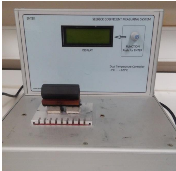
Şekil 3. 3 Seebeck katsayısı ölçüm cihazı
