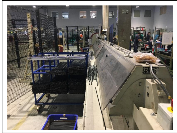
Şekil 7. 5 Şekillendirme fabrikası boru kesim prosesi
