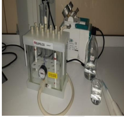
Şekil 3.8 Katı faz ekstraksiyon düzeneği
