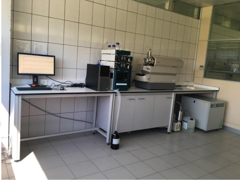
Şekil 3.6 Ekspert Liquid Chromatography (AB Sciex 3200 Eksigent, USA)
