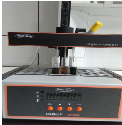
Şekil 3.9 Techne Dri Block DB100/3, Azot altında uçurma cihazı
