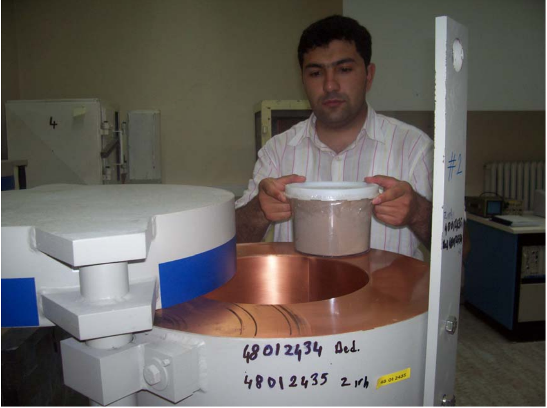
Şekil 4.5 Örneklerin detektöre yerleştirilmesi.
