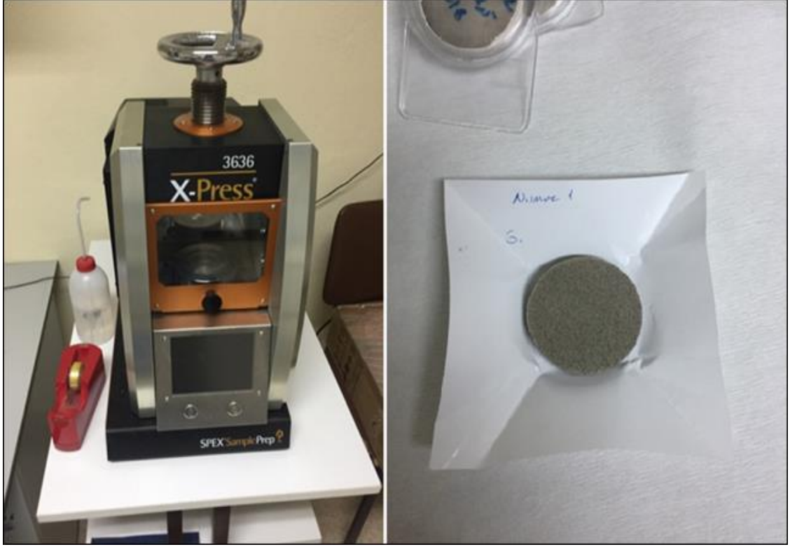
Şekil 6. 10 Selülozlu sediment numunelerinin preslenmesi.
