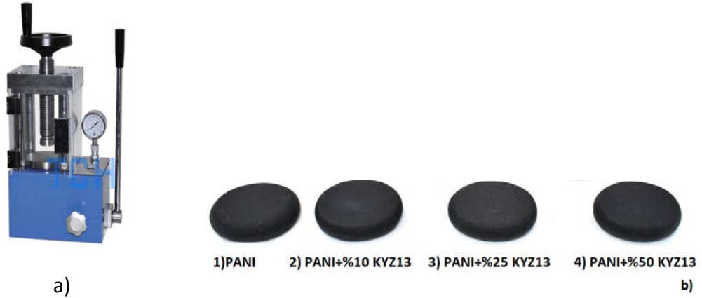
Şekil 3.4 a) Tek eksenli pres cihazı, b) hazırlanan örneklerin görünümü
