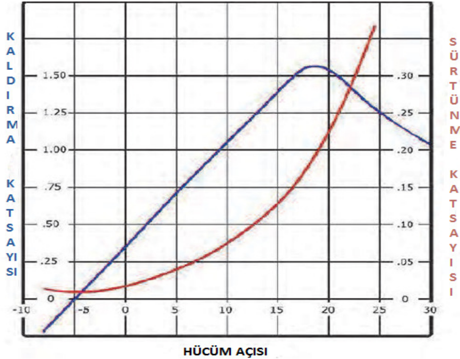
Şekil 3. 10 Kanat kesiti üzerindeki sürükleme ve kaldırma kuvveti
