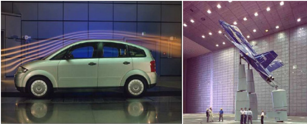
Şekil 2. 2 Otomobilin aerodinamik çalışmaları ve uçak testlerinde kullanılan tüneller
