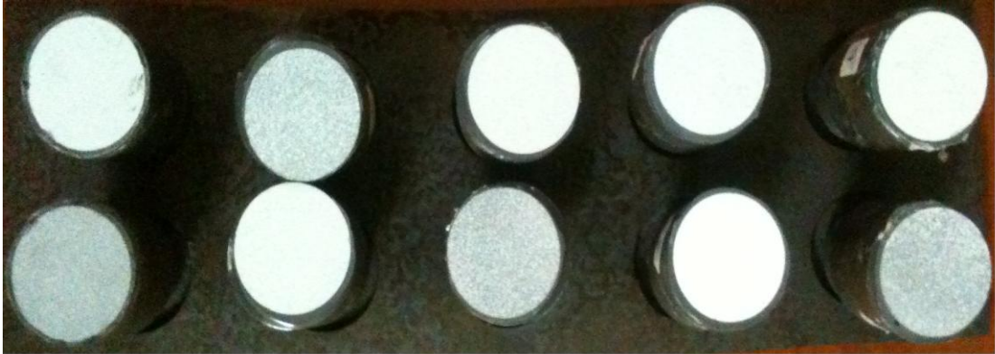
Şekil 4. 11 Çekme deneyi sonrası kaplamaların makro görüntüleri
