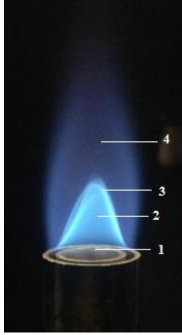
Şekil 2. 1 Ön Karışımli Bunsen bekinde alevin görünümü (1.Yakıtça zengin bölge 2. Yanmanın başladığı yakıtça zengin bölge 3.Stokiometrik yanma bölgesi 4.Eksik yanma bölgesi)
