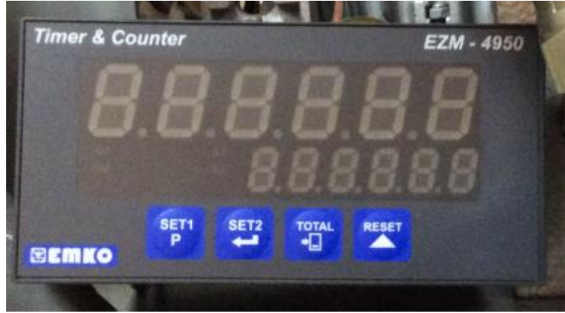
Şekil 2.20 Pulse tipi çıkışı anlık olarak lt/dk'ya çeviren takometre
