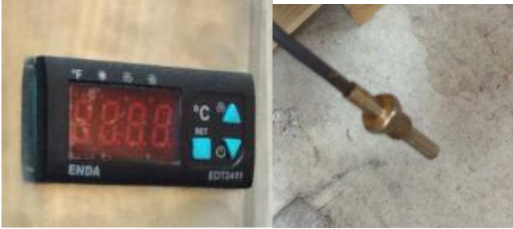
Şekil 2.18 Soldan sağa sıcaklık kontrol cihazı ve sensörü
