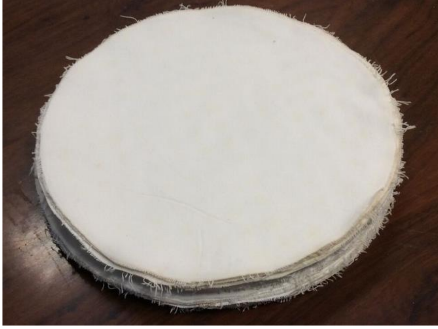
Şekil 2.24 Tekstil mamulünün kesilip ve üst üste düzgün bir biçimde serilerek deneyler için hazırlanması
