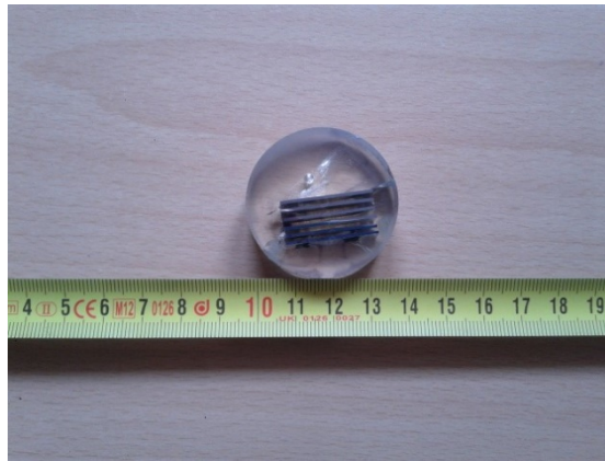
Şekil 4.30 TIG kaynak çalışmalarının mikro yapı görüntüleme numunesi
