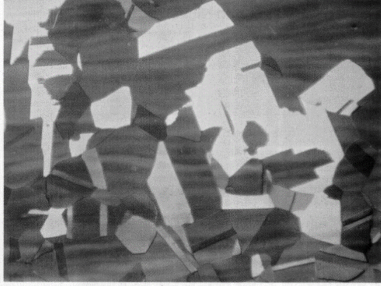
Şekil 2.22 Östenitik paslanmaz çeliğin mikro yapısı [24]
