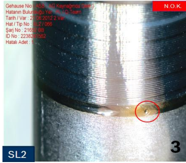
Şekil 4. 19 Kaynak dikişinde boşluk
