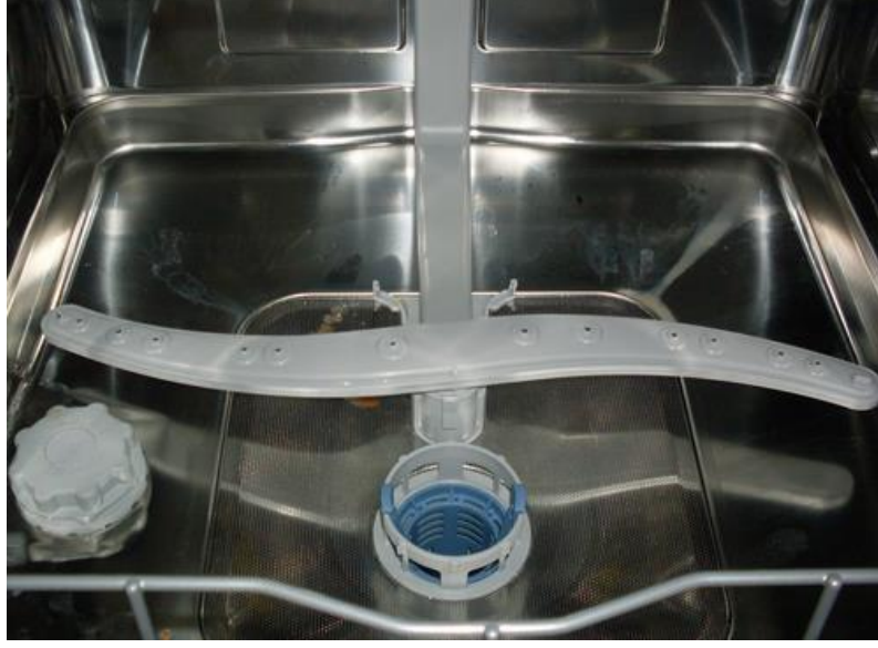
Şekil 2. 28 Yıkayıcılarda pervanenin konumu [14]
