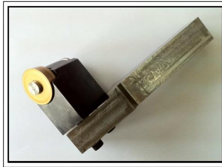
Şekil 3.39 Deneysel çalışmada kullanılan dönen yuvarlak uçlu takım [42]
