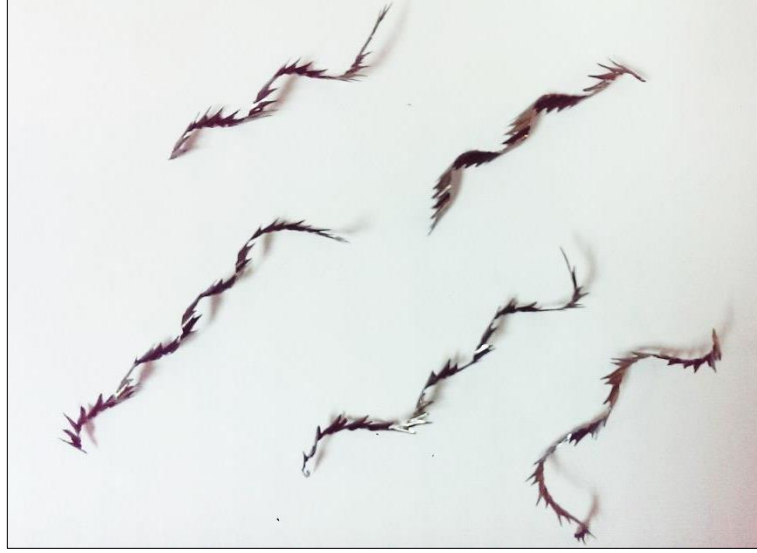
Şekil 4.41 1.2738 iş parçasından 3.deney şartı için ( V=100\text{m/dak} , f=0.2\text{mm/dev} , a=1.5\text{mm} , i=30^\circ ) kırılan talaşlar
