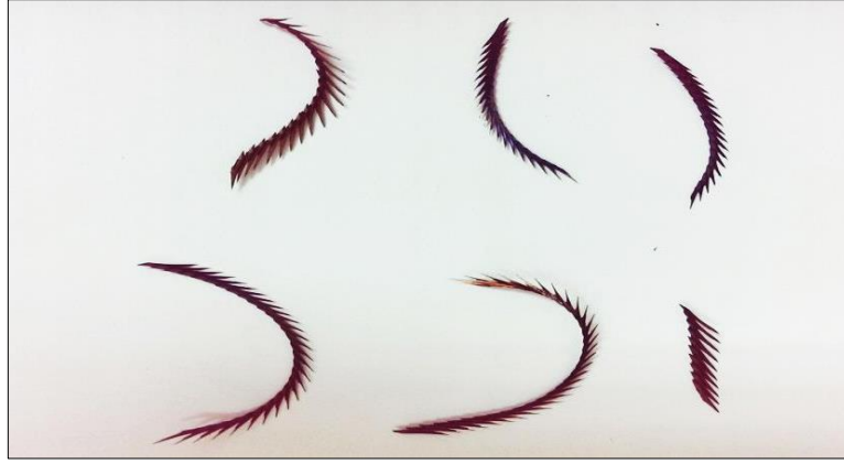
Şekil 4.38 1040 iş parçasından 1.deney şartı için ( V=100\text{m/dak} , f=0.05\text{mm/dev} , a=0.5\text{mm} , i=10^\circ ) kırılan talaşlar
