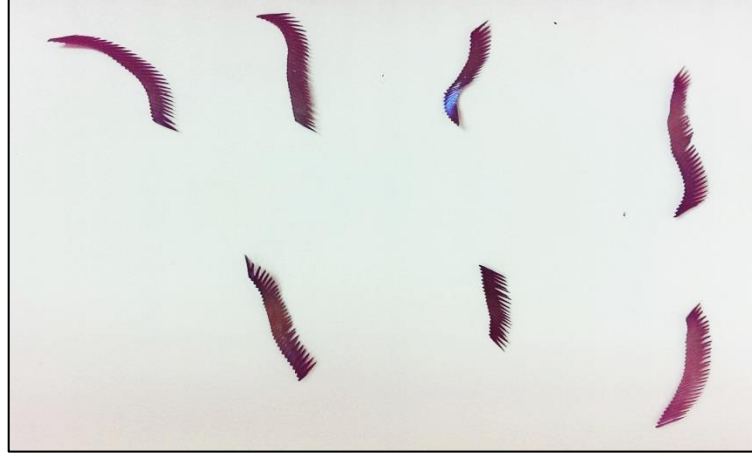
Şekil 4.38 1040 iş parçasından 1.deney şartı için ( V=100\text{m/dak} , f=0.05\text{mm/dev} , a=0.5\text{mm} , i=10^\circ ) kırılan talaşlar
