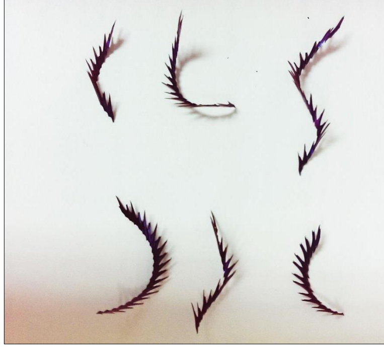
Şekil 4.43 1.2343 iş parçasından 3.deney şartı için ( V=100\text{m/dak} , f=0.2\text{mm/dev} , a=1.5\text{mm} , i=30^\circ ) kırılan talaşlar
