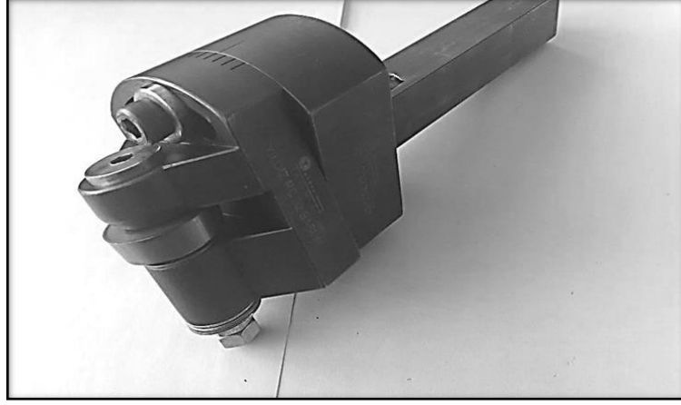
Şekil 4.16 Takımsaş firması desteği ile imal edilen dönen yuvarlak uçlu takım
