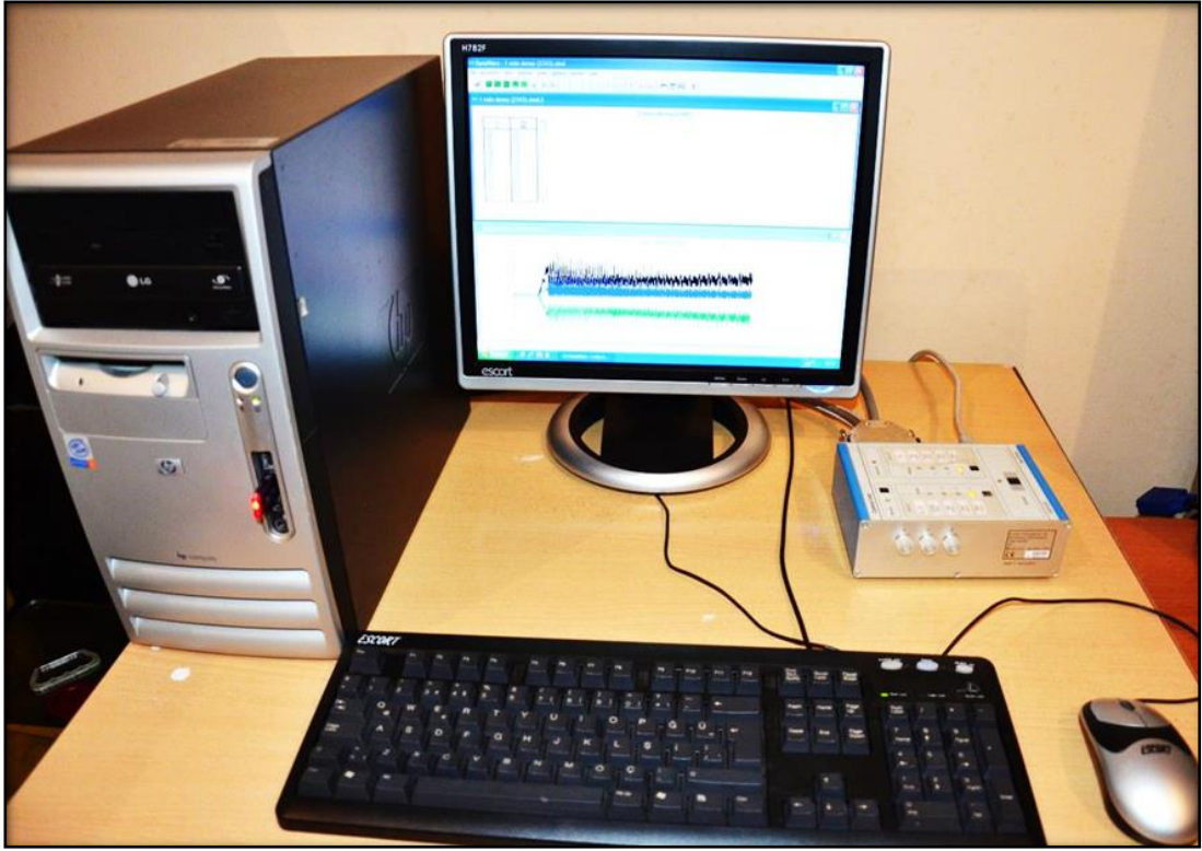
Şekil 4.22 Dinamometre kontrol ünitesi ve bilgisayar veri toplama
