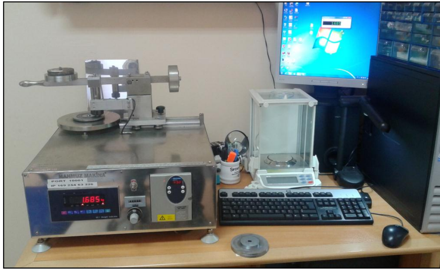
Şekil 3.1 Çalışmalarda kullanılan Pin-On Disk test cihazı
