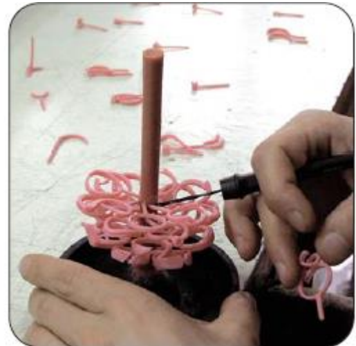
Şekil 2. 26 Mum modellerin sap mumu üzerindeki konumu ve sap mumuna havaya ile dizilmesi [8]
