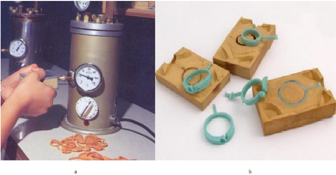
Şekil 2. 21 a. Mum kazanından kauçuk kalıba mum enjekte edilmesi b. Hazırlanan mum modeller [35]
