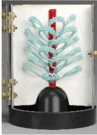
Şekil 2. 10 Dereceli hassas döküm kalıbı kesiti [26]
