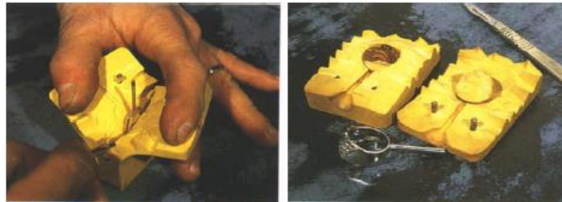
Şekil 2. 18 Kauçuk kalıbın kesim işlemi ve ana modelin çıkarılması [34]
