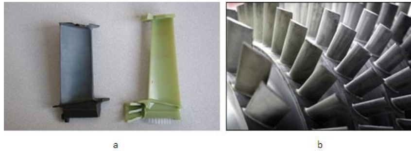
Şekil 2. 3 a. Mum modeli ile birlikte türbin kanadı b. Kayıp mum tekniği ile üretilen türbin [19]
