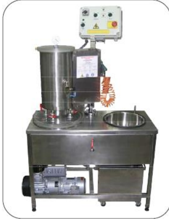
Şekil 2. 29 Otomatik alçı karıştırma ve vakumlama makinesi [8]
