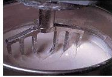
Şekil 2. 28 Alçının elle ve otomatik olarak karıştırılması [35]
