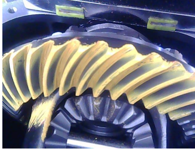
řekil 4. 5 Diř İzinin Kontrol Edilmesi
