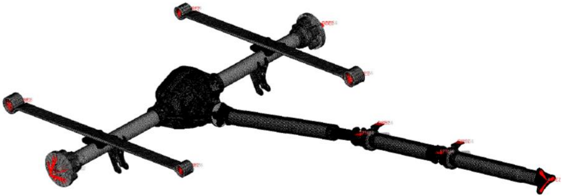
Şekil 6. 15 Aksın Süspansiyon Braketi ve Aks Millerinden Sabitlenmesi
