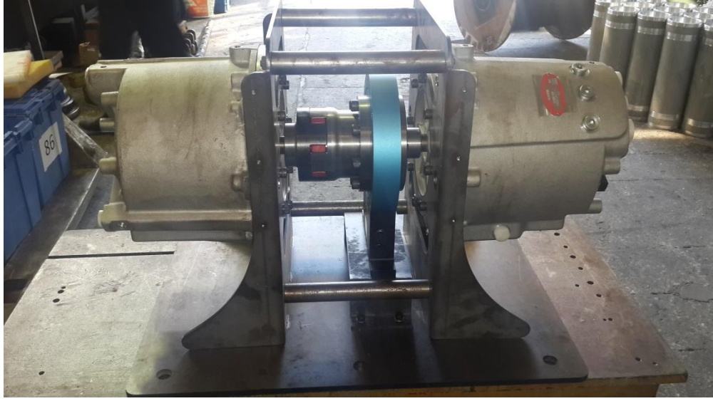
Şekil 5. 13 Motor kuplajı imalat aşaması
