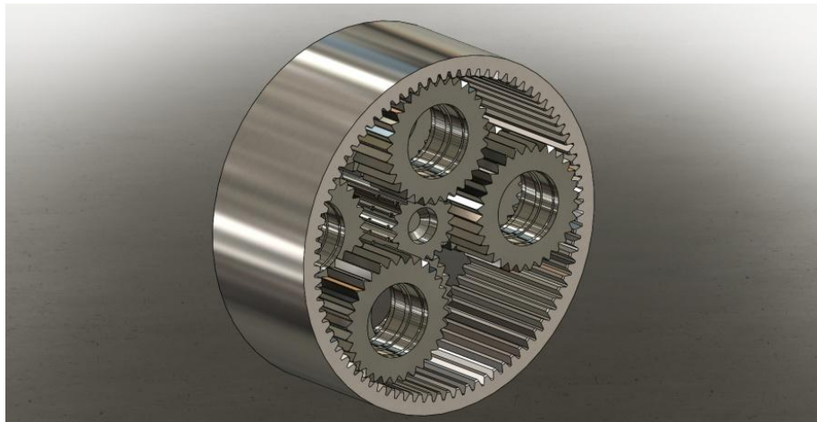
Şekil 4. 17 Dişli kutusu 3 boyutlu tasarımı
