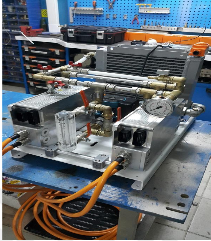
Şekil 5. 9 Rinehart motor sürücü soğutma sistemi tasarımı ve imalatı
