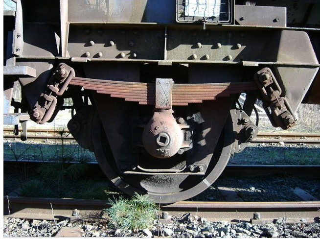
Şekil 3.1 Tek akslı yük vagonu bojisi
