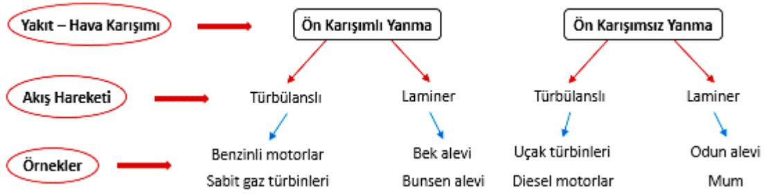
Şekil 2.5 Yakıt - hava karışımı ve akış hareketine göre yanmanın sınıflandırılması
