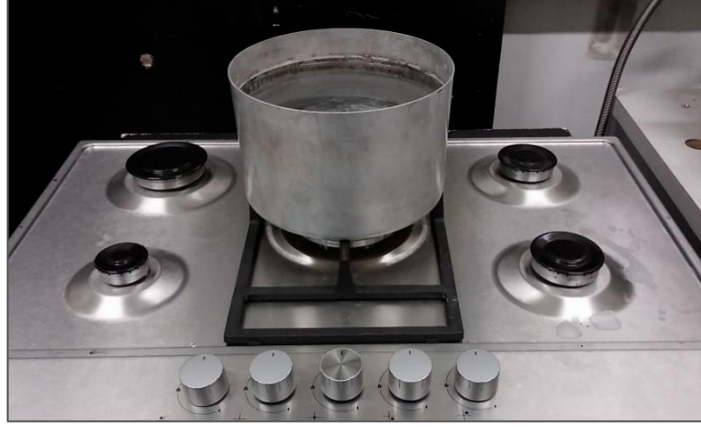
Şekil 5.1 Verim deneyinde 220 mm çapındaki tencereyle ön ısıtma
