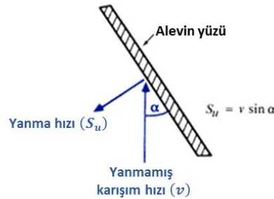
Şekil 2.3 Yanma hızı ile yanmamış karışım hızı arasındaki ilişki
