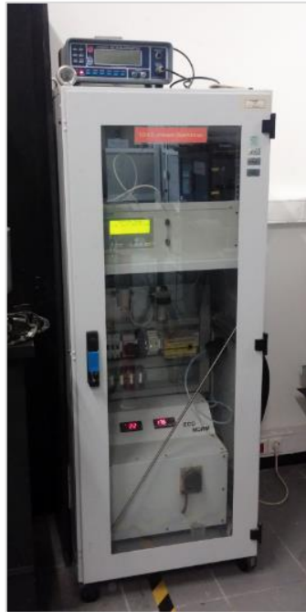
Şekil 5.4 CO-CO 2 Gaz analizörü
