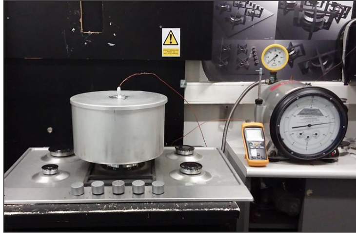
Şekil 5.2 Verim deneyi düzeneği
