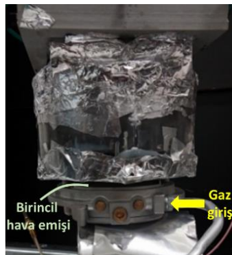
Şekil 5.9 Tünelde bağlanmış durumdaki referans yakıcı
