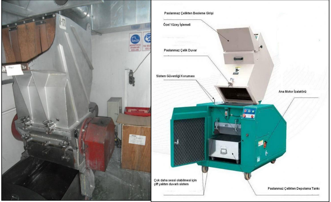
Şekil 6.16 Mevcut plastik kırma makinesi ve yeni tesis edilen kırma makinesi
