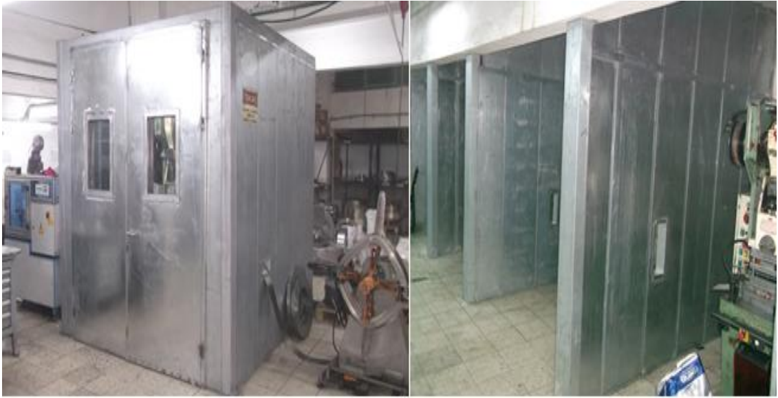
Şekil 5.14 Fabrika içi pres kabini ve pres grubu kısmi hücre uygulamaları
