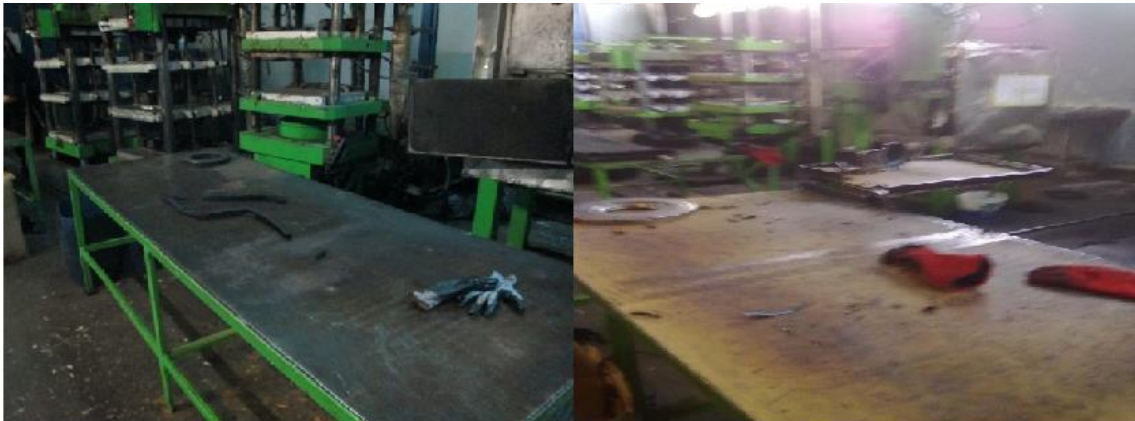
Şekil 6.13 Kalıp sökme çalışma masasının kauçuk ile kaplanması
