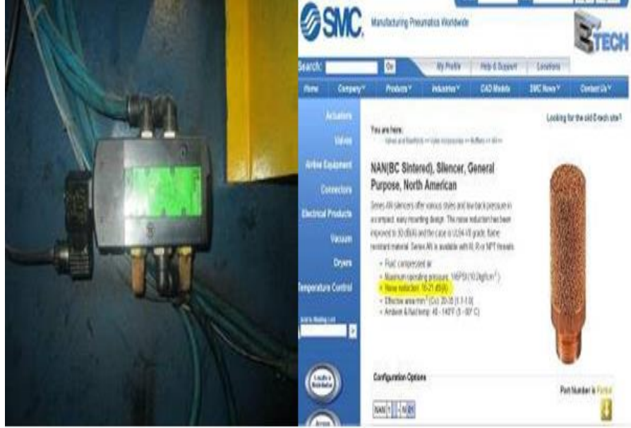
Şekil 6.8 Banbury için susturucu takılması
