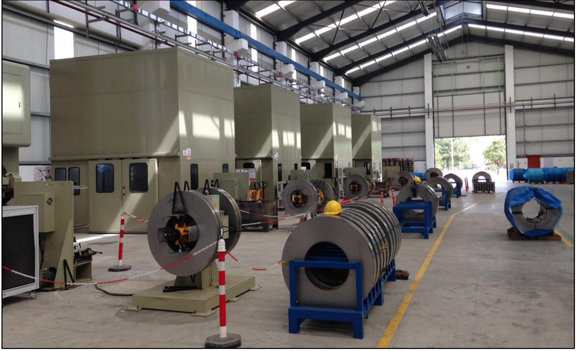
Şekil 6.21 Çelik servis merkezi fabrika içi gürültü kabinleri
