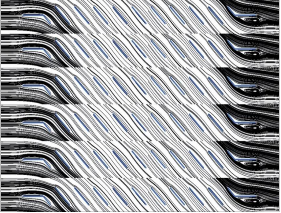
Şekil 3.41 Kanat adımı F_p=3 mm, panjur açısı \beta=40^\circ ve serbest akım hızı U=1.5 m/s için akım çizgileri
