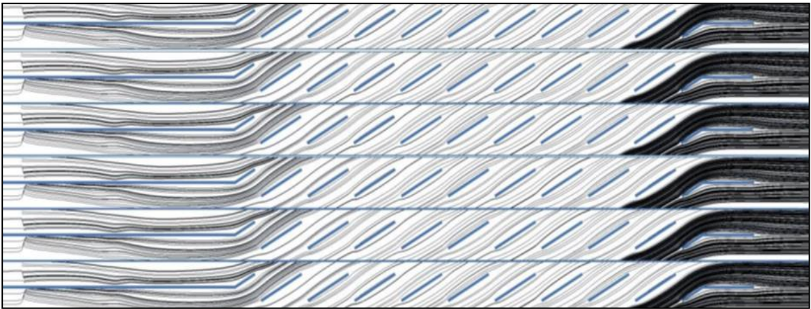
Şekil 3.64 Kanat adımı F_p=3 mm, panjur açısı \beta=30^\circ ve serbest akım hızı U=1.5 m/s için akım çizgileri (Yan düzlem, çıkış bölgesi)
