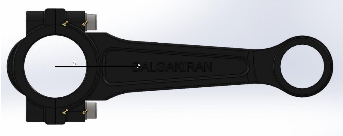
Şekil 3.3 Üç kademeli pistonlu kompresöre ait biyel kolu ve ağırlık merkezi konumu
