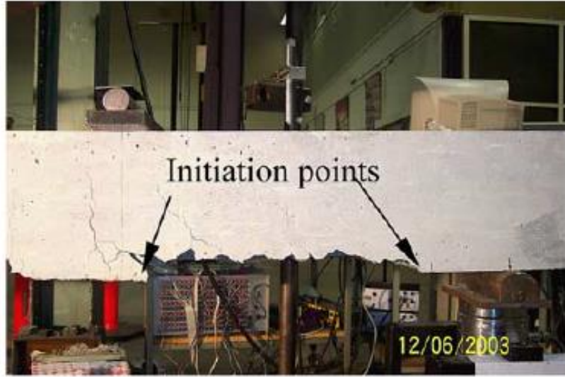
Şekil 4.8 Pham araştırmacısının S3b beton kirişine ait kopmalar [18]
