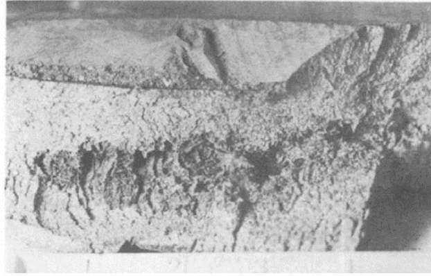
Şekil 4.33 Kalın kesitte besleme hatasına bağlı çekinti boşluğu [22]
