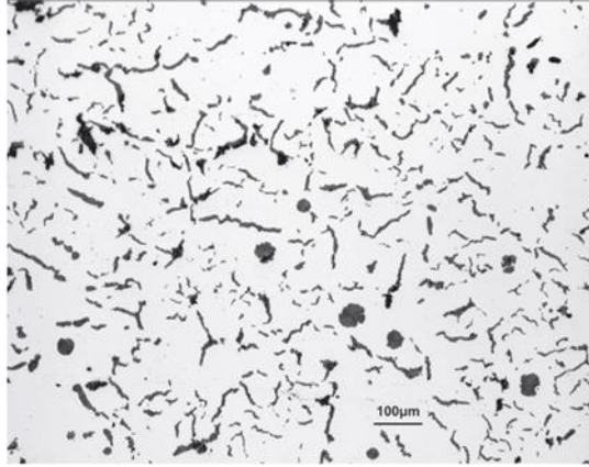
Şekil 3.4 %10,9 Nodularite'de KGDD malzeme Mikro Yapısına Ait Görüntü [17]
