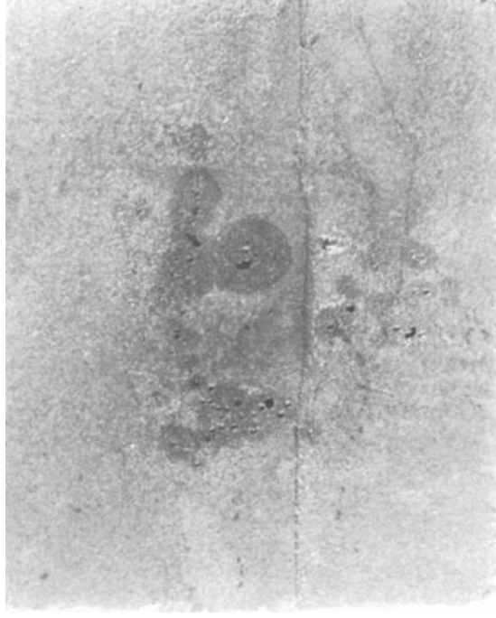
Şekil 4.25 Numune Yüzeyinde Görülen Karınca Hatası Örneği [22]
