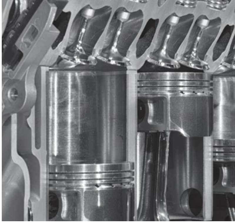
Şekil 2.2 Kuru Gömlek'li Bir Motor Bloğu [12]
