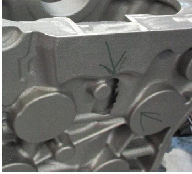
Şekil 4.30 Eksik Döküm Hatalı bir Motor Bloğu Numunesi
