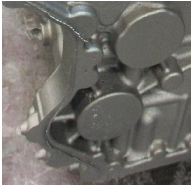
Şekil 4.32 Motor bloğu dökümünde karmaşık geometrili bölgedeki gaz sakatı
