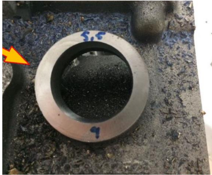
Şekil 4. 35 Motor Silindir Kafası dökümünde maça hareketine bağlı işleme payı ve et kalınlığı hatası
