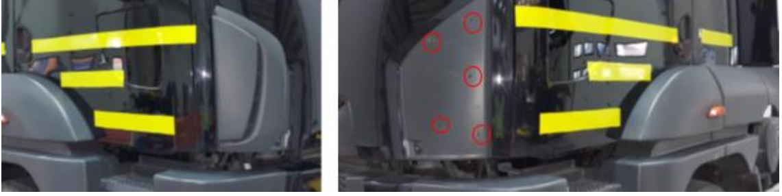
Şekil 3. 2 Hava kanalı parçasının araç üstündeki yeri ve hava kanalının bağlantı noktaları
