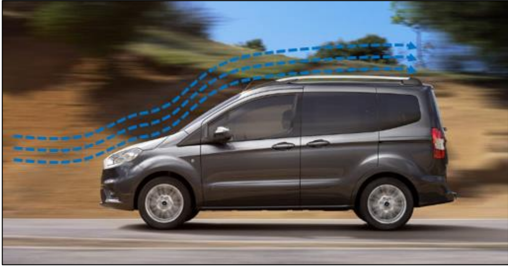
Şekil 2. 1 Belirli bir hızda Hareket eden aracın ön yüzeyinden, arka tarafa doğru yönelen akış [8]
