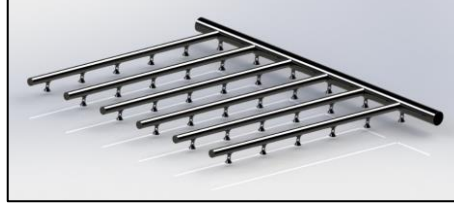
Şekil 3.5 Sıcak Su Dağıtım Sistemi [21]
