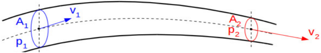
Şekil 3.4 Değişken Çaplı Bir Borudan Geçen Akışkanın Davranışı
