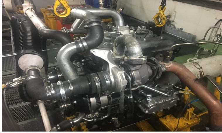
Şekil 6.2 DGT in Motora Entegrasyonu
