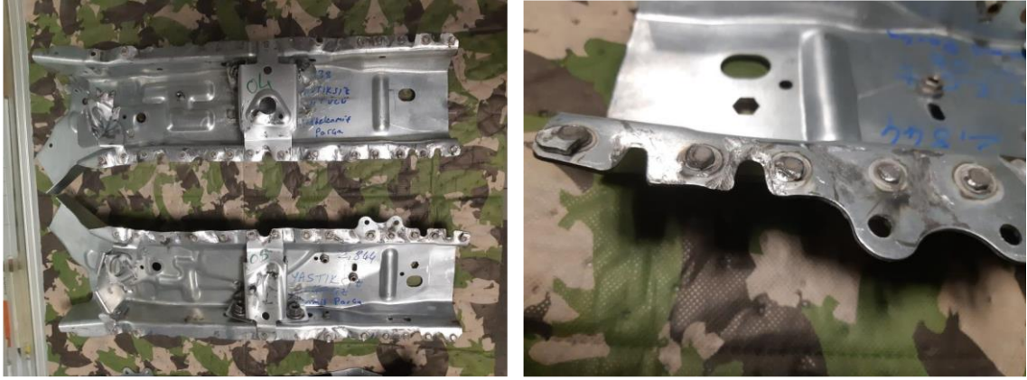
Şekil 4.25 Punta kaynak test numuneleri
