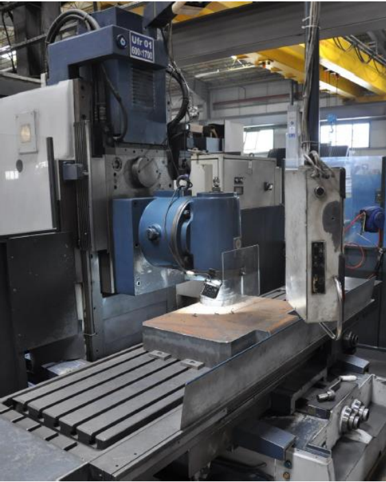
Şekil 4.20 Gövde alt plakası talaşlı üretim
