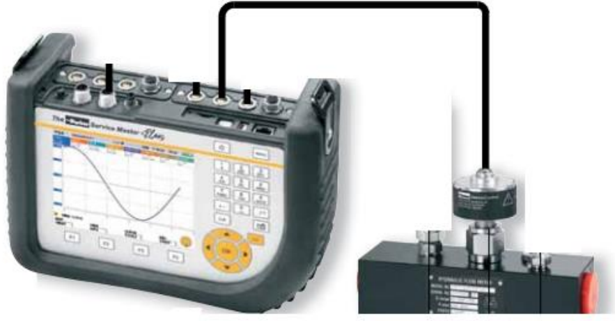
Şekil 4. 20 Debi ölçüm ekipmanı [32]
