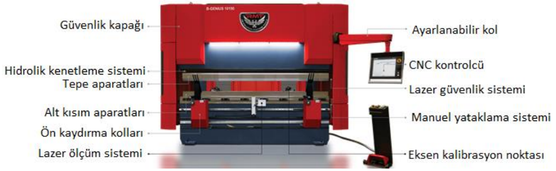
Şekil 2.3 Abkant pres üzerindeki alt sistemler [23]
