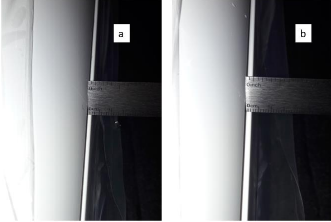
Şekil 5.4 Bant üzeri çarpılma ölçümü – (a) Sıcak Ölçüm (b) Soğuk Ölçüm
