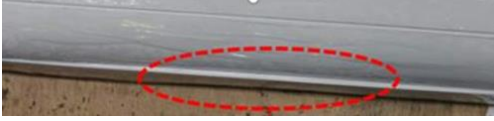
Şekil 4.2 Şasi parçasının montajı sonrası oluşan çarpılmanın fotoğrafı
