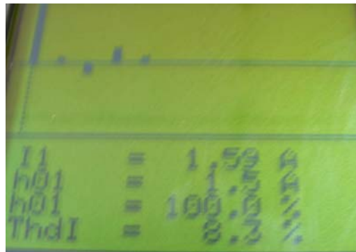
Şekil 11.30 Şebeke girişindeki toplam akım harmoniği.
