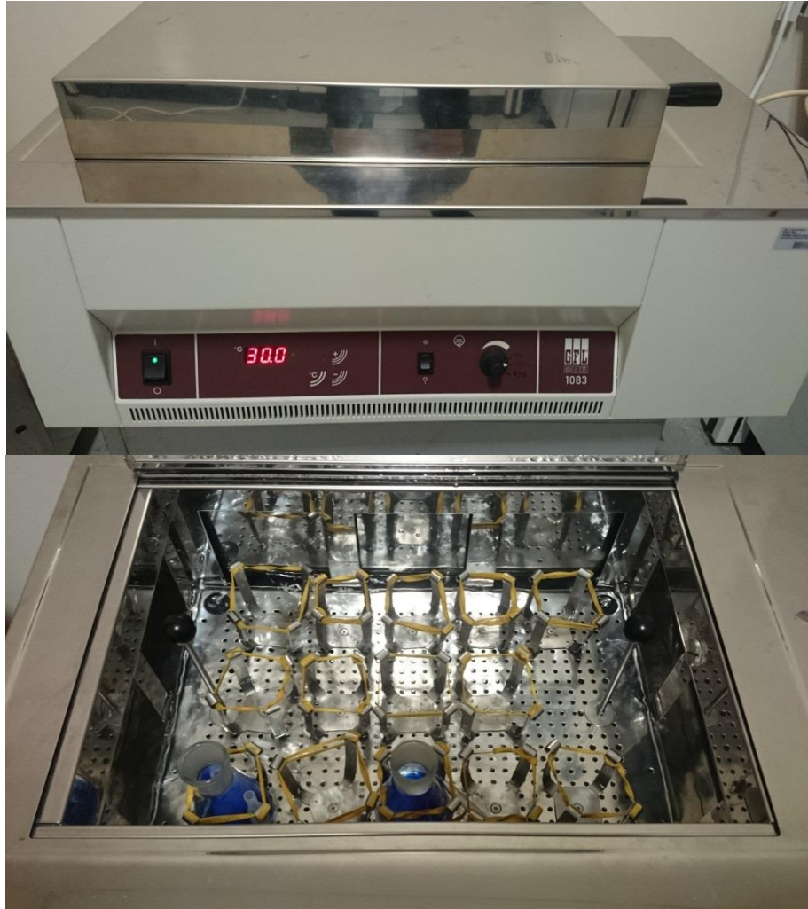
Şekil 5. 1 Denemelerde kullanılan sabit sıcaklıklı, çalkalamalı su banyosu
