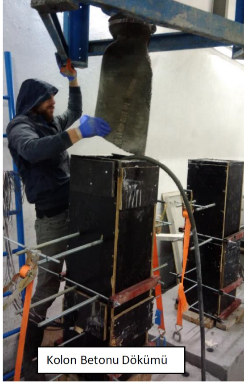
Şekil 2.3 S351008-S352008-S353508 kolonlara ait imalat fotoğrafları
