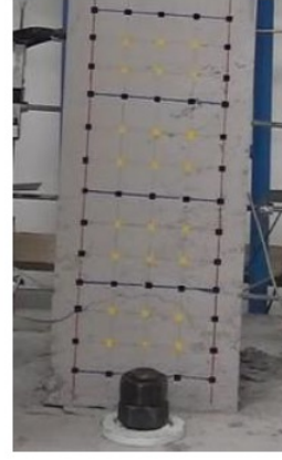
%2.8 (sargısız betonda ezilme)
