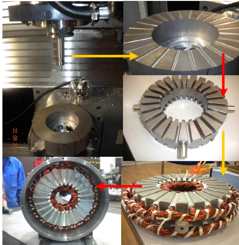
Şekil 7.7 EASM disk motor statorunun üretim aşamaları
