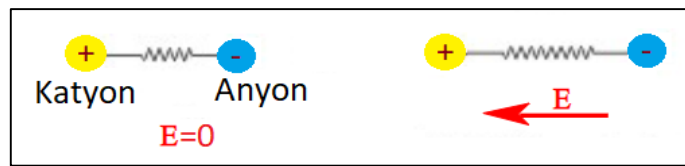
Şekil 2. 22 Atomik polarizasyonun bir iyon çifti için temsili gösterimi.
