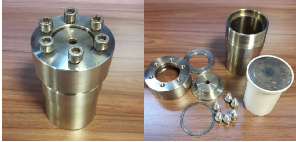
Şekil 3. 5 Paslanmaz çelik otoklav
